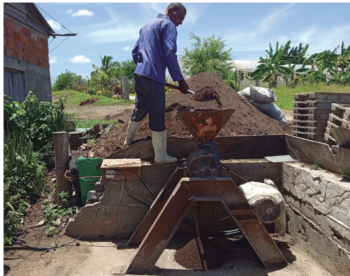
La máquina confeccionada por Frank Hernández Pérez posibilita la elaboración del sustrato para las bandejas de los semilleros.
