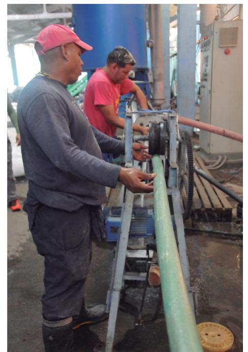
En esta máquina extrusora se fabrican mangueras y tuberías, destinadas a los sectores de la Agricultura y la Construcción.
